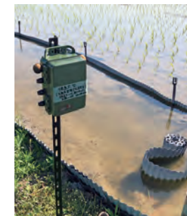
音声記録装置 音声データを解析し両生類や鳥類の生息状況を調べます。
